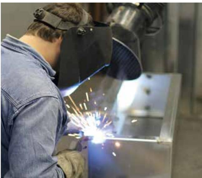
Fertigung einer Blech-Schallschutzhaube
