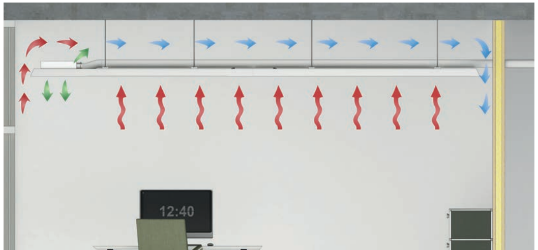
Funktionsweise Plafotherm® DS AirHybrid
