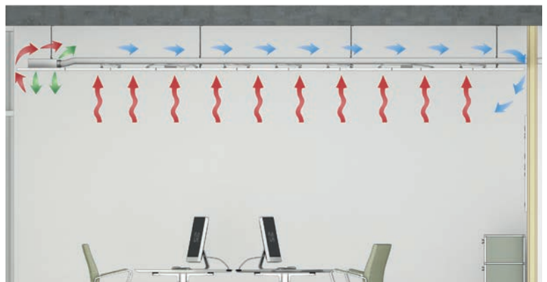
Funktionsweise Plafotherm® B/E AirHybrid
